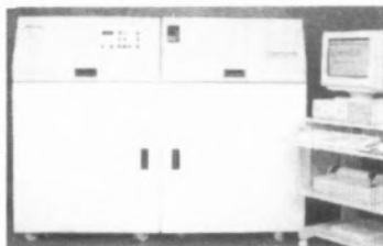
SPECTROMASS - ICP Espectrómetro de massa - ICP para análise de vestígios de elementos e isótopos.
