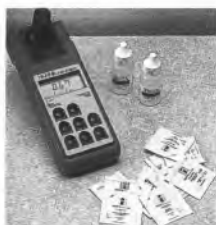
A1. Medidor Portátil para Análise da Água: Mede Turvação, pH, Cloro, Bromo, Ferro, Iodo e Ácido Cianúrico
