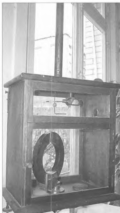
Figura 1 Balança magnética utilizada por Georges Urbain para medição dos coeficientes de magnetismo das terras raras
