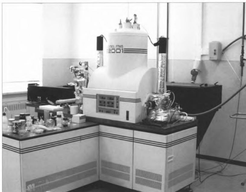
figura 3 – Vista geral do espectrómetro de massa de ressonância ião-ciclotrão. O cilindro horizontal contém, para além de azoto e hélio líquidos, o magneto supercondutor.
