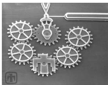
Figura 1 Imagem de uma micromáquina feita de silício. As seis rodas dentadas são movimentadas sequencialmente. (Cortesia dos Sandia National Laboratories, SUMMIT™ Technologies, http://mems.sandia.gov )
