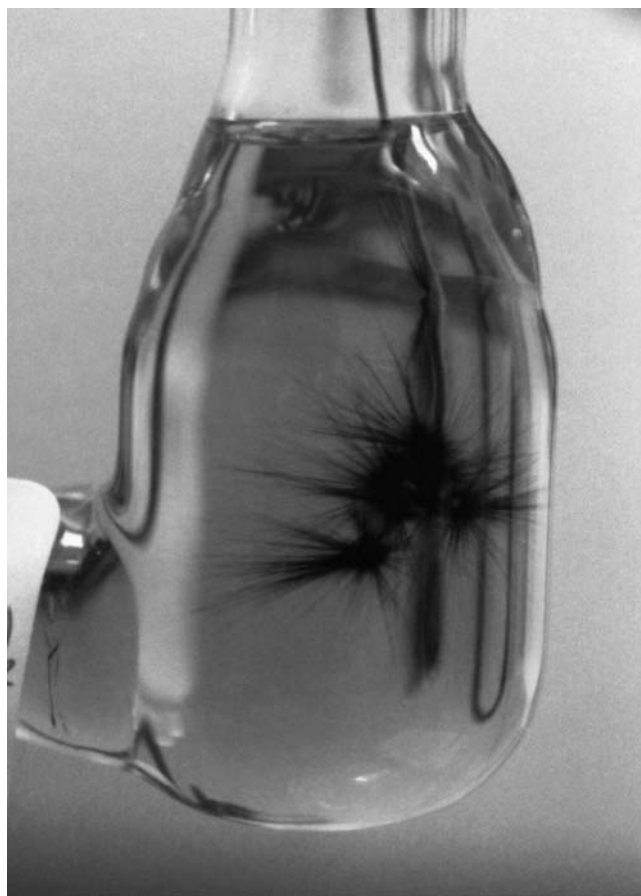
Figura 2 Fotografia de cristais em crescimento sobre um eléctrodo de platina segundo a técnica de electrocristalização.
