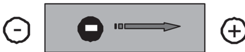
Figura 9 Representação esquemática de uma célula pertencente ao equipamento de espectroscopia de correlação fotónica com dois eléctrodos e uma amostra de um lipossoma carregado negativamente
