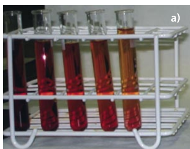
Figura 1 Solução de azul de timol em diferentes graus de diluição em água; a) com adição de HCl (aq); b) com adição de KOH (aq)
