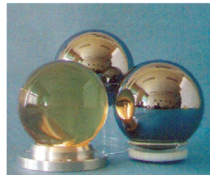
Figura 4 Cristal de silício, com número de átomos e volume bem determinados, candidato a referência do kg padrão, comparado com duas esferas análogas feitas em prata
