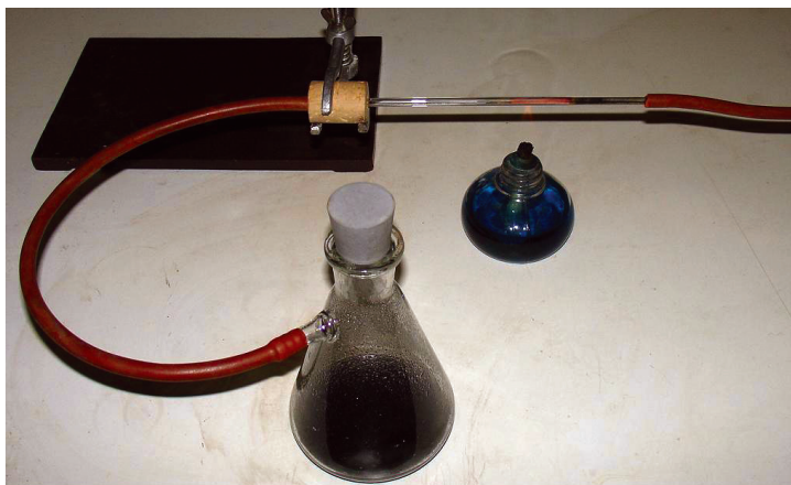
Figura 1 Montagem para a preparação de di-hidrogénio e redução de óxido de cobre (II)
