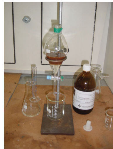
Figura 2 – Extração da cafeína com o solvente diclorometano, sendo visível a existência de uma emulsão
