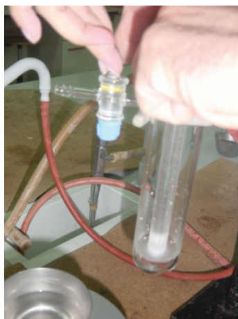
Figura 3 – Purificação do crude por sublimação em supressão
