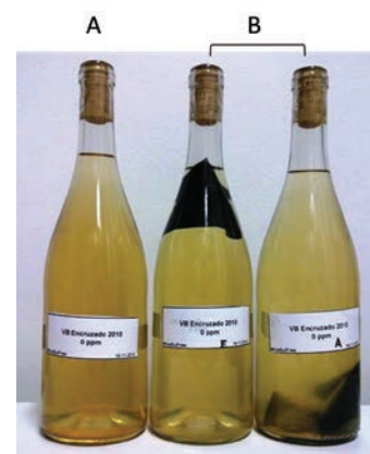
Figura 6 – Vinho branco experimental produzido pela Dão Sul S.A.: A) vinho sem tratamento; B) vinho com o filme à base de quitosana
