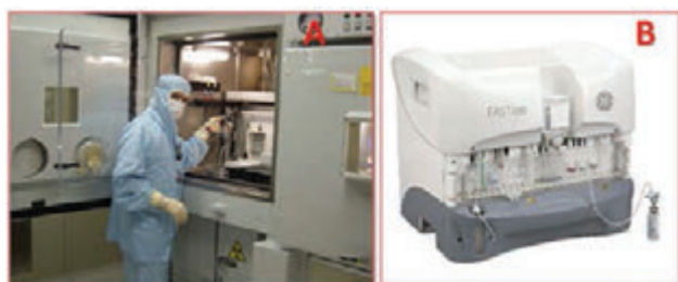
Figura 11 – A) Hot cell adequada para a produção de radiofármacos; B) Módulo automático de síntese da ^{18}\text{F} -FDG da GE Healthcare
