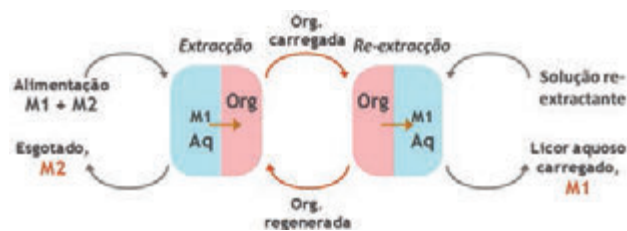
Figura 7 – Diagrama simplificado de separação dos metais M1 e M2 num circuito de extracção por solventes
