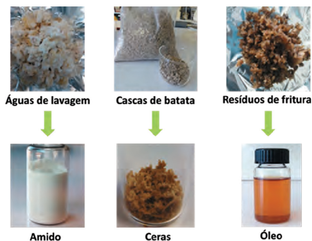
Figura 1 – Matérias-primas recuperadas dos subprodutos provenientes da empresa de batata frita “A Saloinha” com vista à elaboração de bioplásticos.
