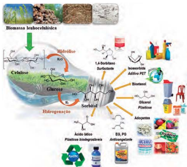
Figura 2 – Esquema ilustrativo da hidrogenação hidrolítica da celulose em sorbitol e algumas das suas possíveis aplicações.
