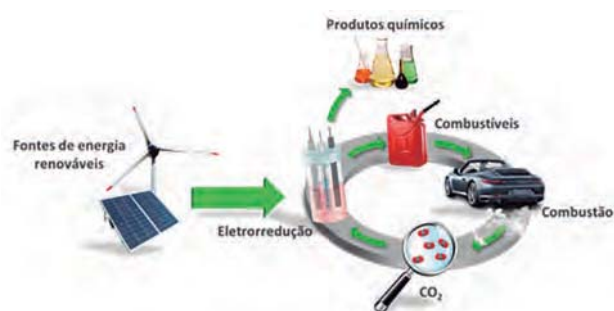
Figura 1 – A eletrorredução de \text{CO}_2 acoplada a fontes de energia renováveis, como a eólica e a solar, pode possibilitar um ciclo energético livre de \text{CO}_2 , no qual o \text{CO}_2 é convertido em combustíveis e produtos químicos de forma renovável e sustentável.
