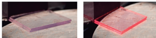
Figura 9 – Fotografias de um LSC à base de um cristal líquido dopado com uma mistura de corantes orgânicos à temperatura ambiente (esquerda) e após aquecer até atingir 85 °C (direita). Reproduzido, com permissão, da ref. [53].
