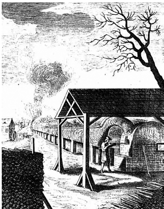
Figura 1 – Oficina e forno para a ustulação do minério de cobalto, na Saxónia [10].
