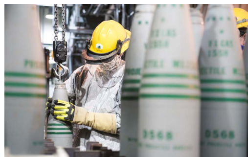
Figura 3 – Operador a manipular um projétil contendo VX para dar início ao seu processo de destruição. Crédito: PEO ACWA.
