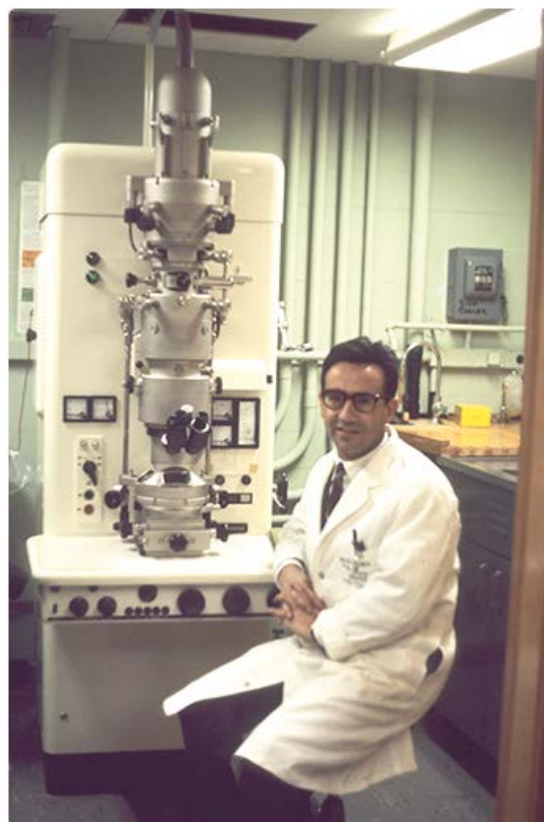
Figura 2d - Prof. David Ferreira com o Microscópio Eletrónico, na Rua da Escola Politécnica - FCUL - medindo o raio do fio de platina - 5,49 \pm 0,08 \mu\text{m} , um dos principais desafios, dezembro de 1974.
